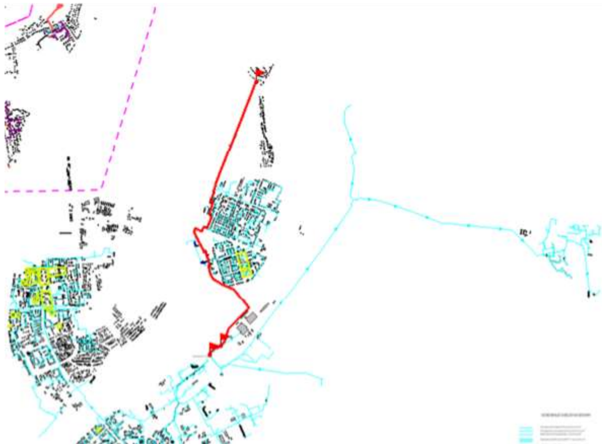
Рисунок 11.8 Путь для расчёта вероятности безотказной работы тепловых сетей от Архангельской ТЭЦ до потребителя ул.70лет Октября, 8
